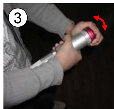
ノズル先端の 赤いスリーブ をひねって開 閉・水量調節
